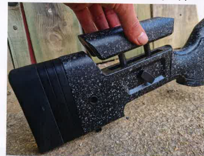
Una de las características principales del Premier HMR Pro es la espectacular culata híbrida, fabricada en material sintético y que esconde en su interior un mini-chasis de aluminio para dar mayor estabilidad al conjunto y contener el retroceso. Es muy ergonómica, adaptándose perfectamente a la mano, y con carrillera regulable y ajustable.
