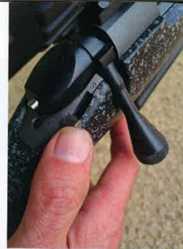
Los Premier tienen un seguro manual con una palanca ubicada en el lado derecho de la acción, en la parte trasera del cerrojo.
